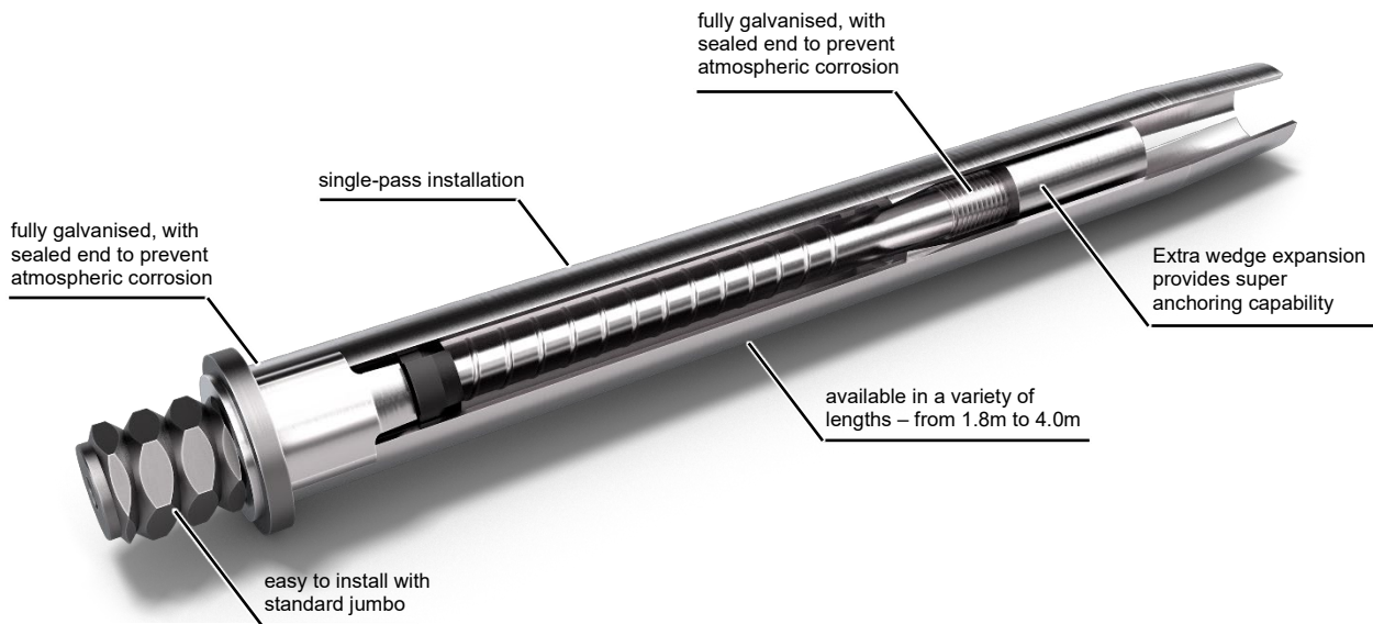
FIG 4 – The MDX bolt.
